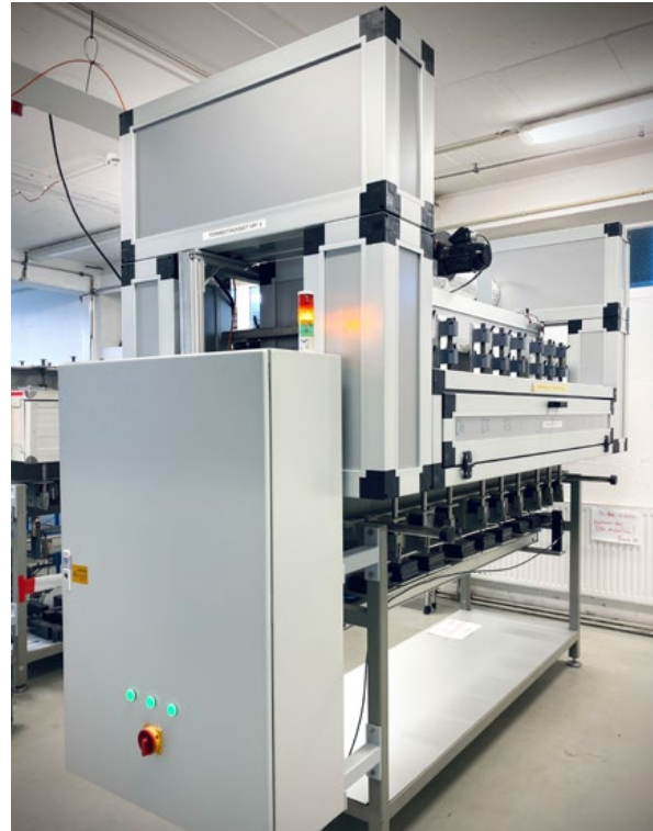
Saniertes Druckprüfstand mit temperierter Prüfkammer
