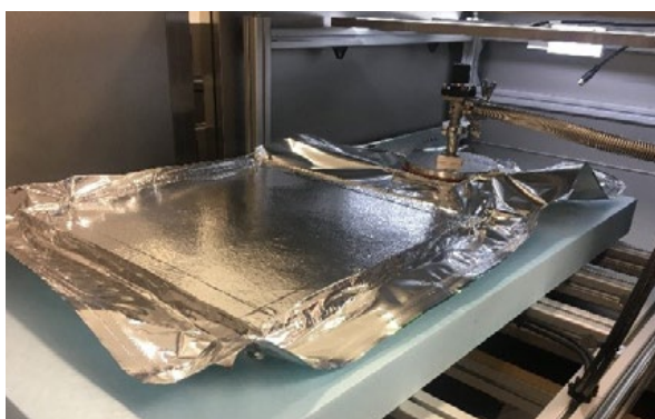
Abb. 2: WoodVIP nach der Evakuierung im Laborprozess
