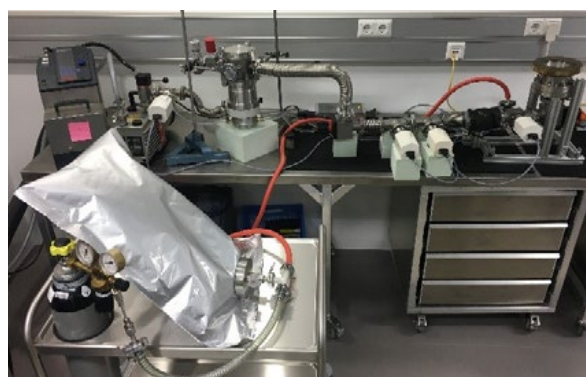
Abb. 1: Blendenmessstrecke zur Bestimmung des Ausgasungsverhaltens von Kernmaterialien
