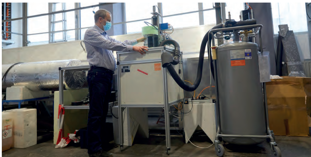
7: Tieftemperaturlabor des FIW München, Gerät zur Bestimmung der Längenausdehnung von Kälte­dämmstoffen
