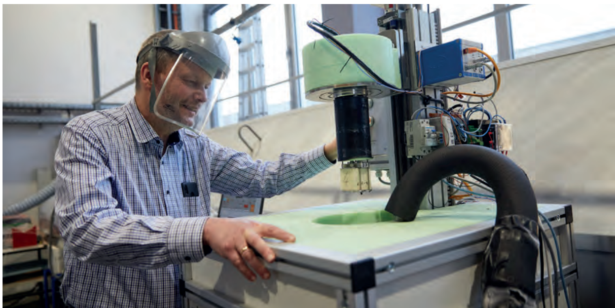
9: Dilatometer für tiefe Temperaturen – Einbau einer Dämmstoffprobe
