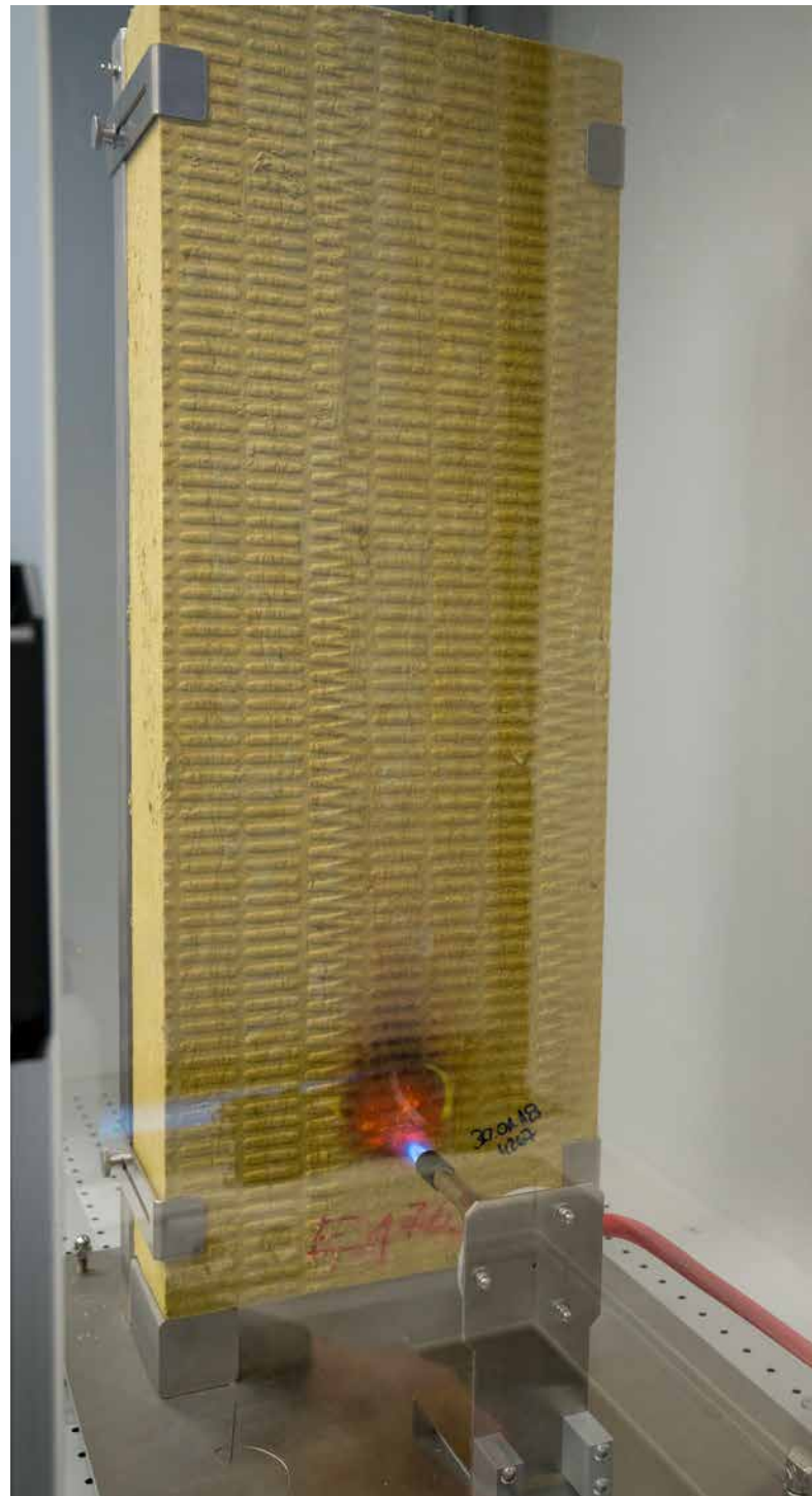
Abb. 1: Gesamtansicht der Prüfeinrichtung nach DIN EN 16733 im FIW München
