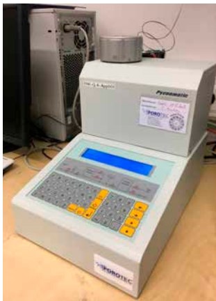
Abb. 15: He-Pyknometer Pycnomatic HTC zur Bestimmung des Feststoffvolumens
