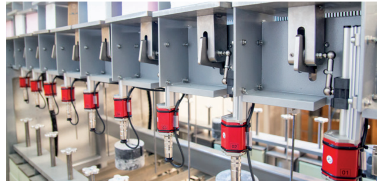
† Neue Prüfstände für das Langzeit-Kriechverhalten
