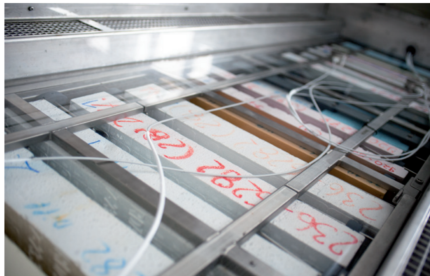
† Prüfeinrichtung zur Bestimmung des Verhaltens bei Frost-Tau-Wechselbeanspruchung
