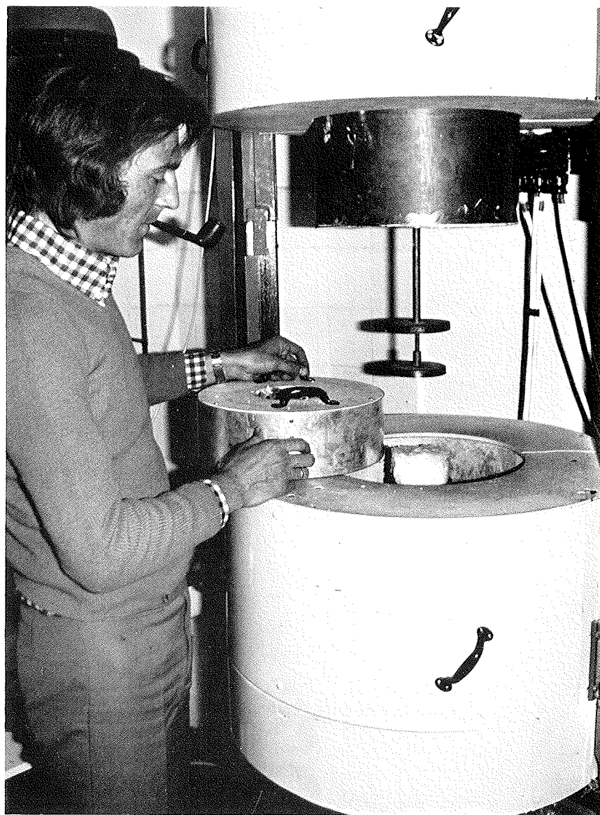
Bild 3: Einbau des Probekörpers in den Prüfraum mit hochgeschobenem Oberteil
