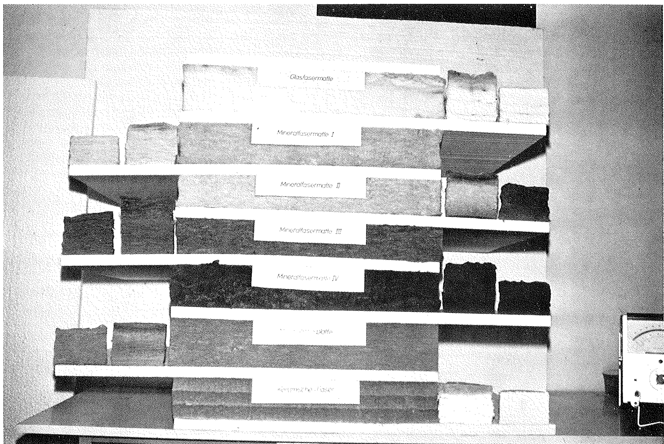
Bild 12: Ansicht der Mineralfaser-Dämmstoffe und der Probekörper nach all- und einseitiger Beheizung
