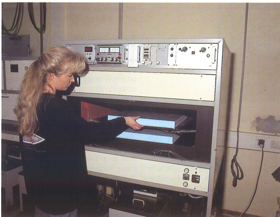
Bild 4: Einbau von zwei Hartschaumplatten in das Wärmeleitfähigkeitsgerät nach DIN 52612.
